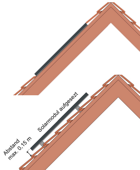
Solarmodul integriert und aufgesetzt, unmaßstäblich, eigene Darstellung
