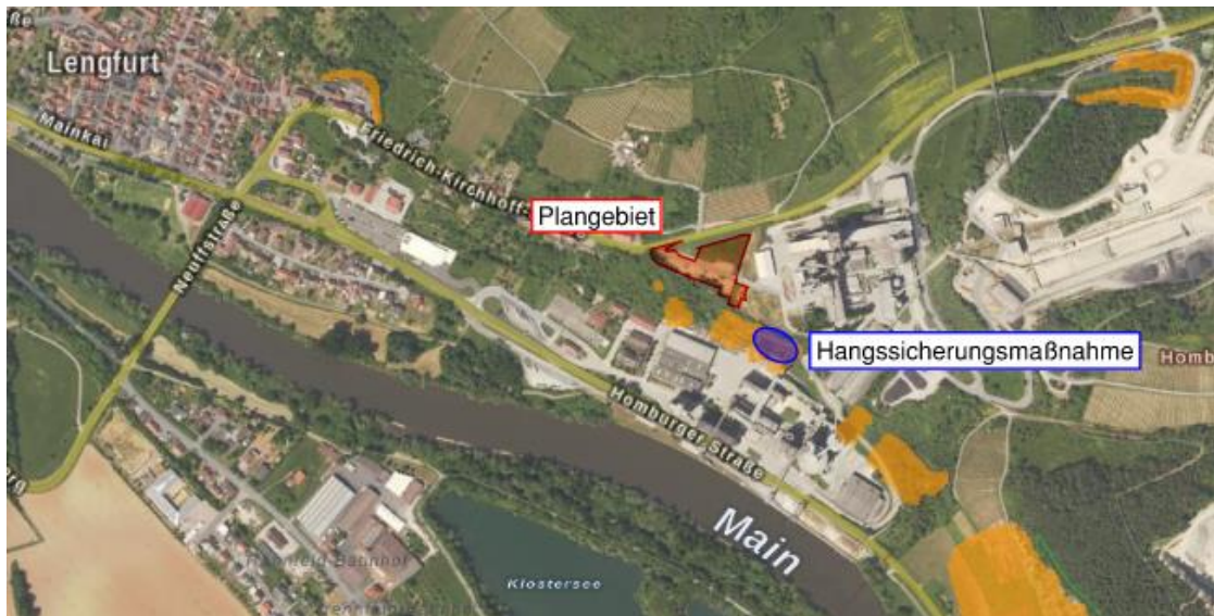
Abb. 8: Gefahrenhinweisbereich für Steinschlag, Blockschlag und Felsstürze; Geltungsbereich rot umrandet, Bereich der durchgeführten Hangsicherungsmaßnahme blau hervorgehoben (Kartengrundlage: BayernAtlas – Bayerisches Landesamt für Umwelt, Bayerische Vermessungsverwaltung, EuroGeographics)
